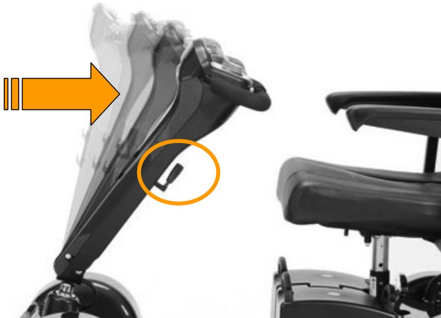
El manillar se libera al girar la palanca hacia la derecha, y se bloquea en posición al soltar la palanca (regulación mediante actuador de gas)
