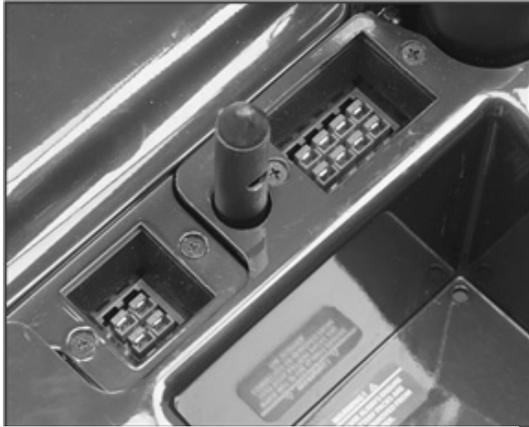
Sin cables ni conexiones, las baterías quedan encajadas cada una en su alojamiento, y conectadas entre si
