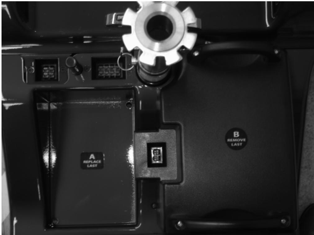
Para instalar las baterías, primero se coloca la B y luego la A.
