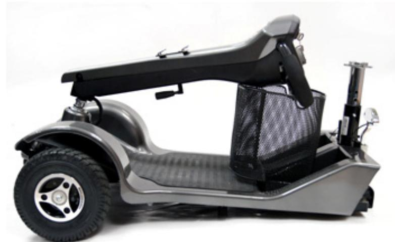
El manillar se pliega totalmente hasta abajo
